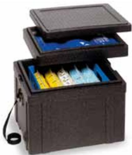
Внутренние габариты коробки Макси 500x400x320 мм и вместимость 65 литров. Она предназначена для транспортировки как холодных так и горячих блюд. Пределы температуры -40°C...+110°C. Для холодной транспортировки поставляется дополнительная крышка для холодного элемента.
