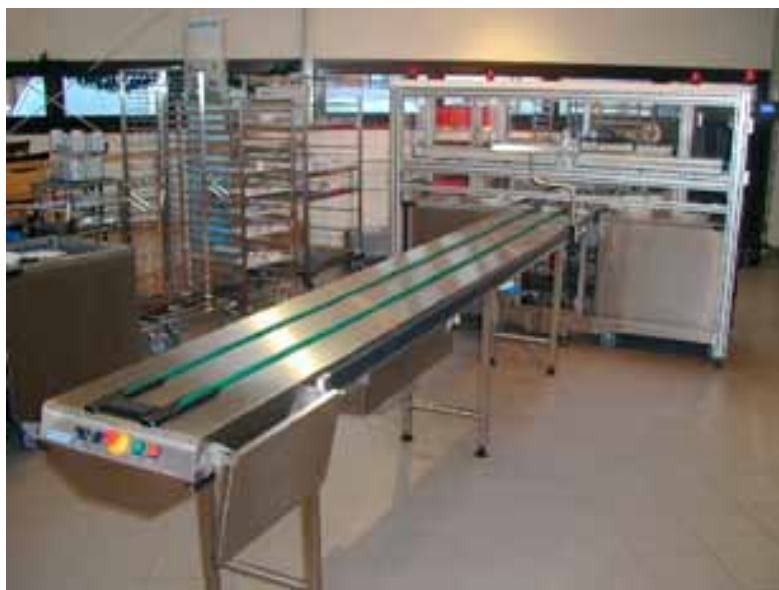
Конвейер с круглыми направляющими, на фотографии с концевым выключателем, дополнительной навесной рабочей столешницей, резиновой защитой и вращающимся рабочим столом.
