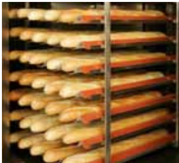
Вращающаяся кассета с направляющими позволяет добиться равномерного результата выпечки.
