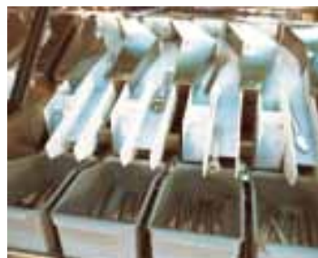
Автомат для сортировки приборов сортирует приборы в правильную коробку, после чего коробки транспортируют в раздачу.
