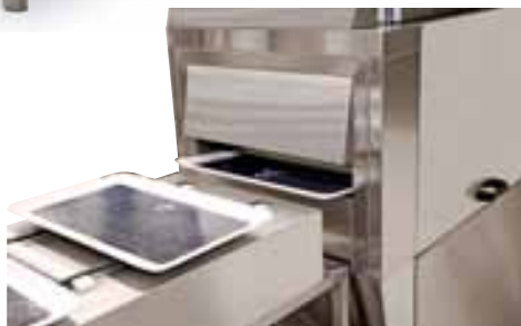
Внешний транспортер подачи подносов перемещает подносы в моечную машину длинной стороной вперед.
