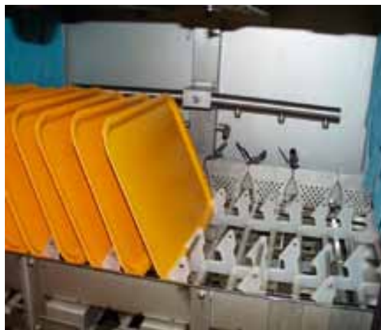
Машина для мытья подносов и столовых приборов Метос ВД 66ЦТ способна мыть как подносы, так и кухонные принадлежности.
