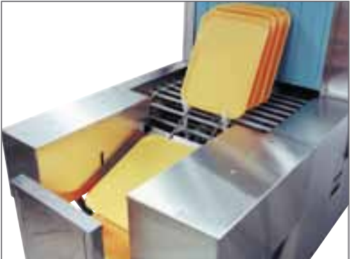
После мытья и сушки машина укладывает подносы на тележку с выжимным устройством для подносов
