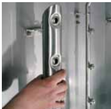
Съемные моющие рычаги для повышения качества чистки.
